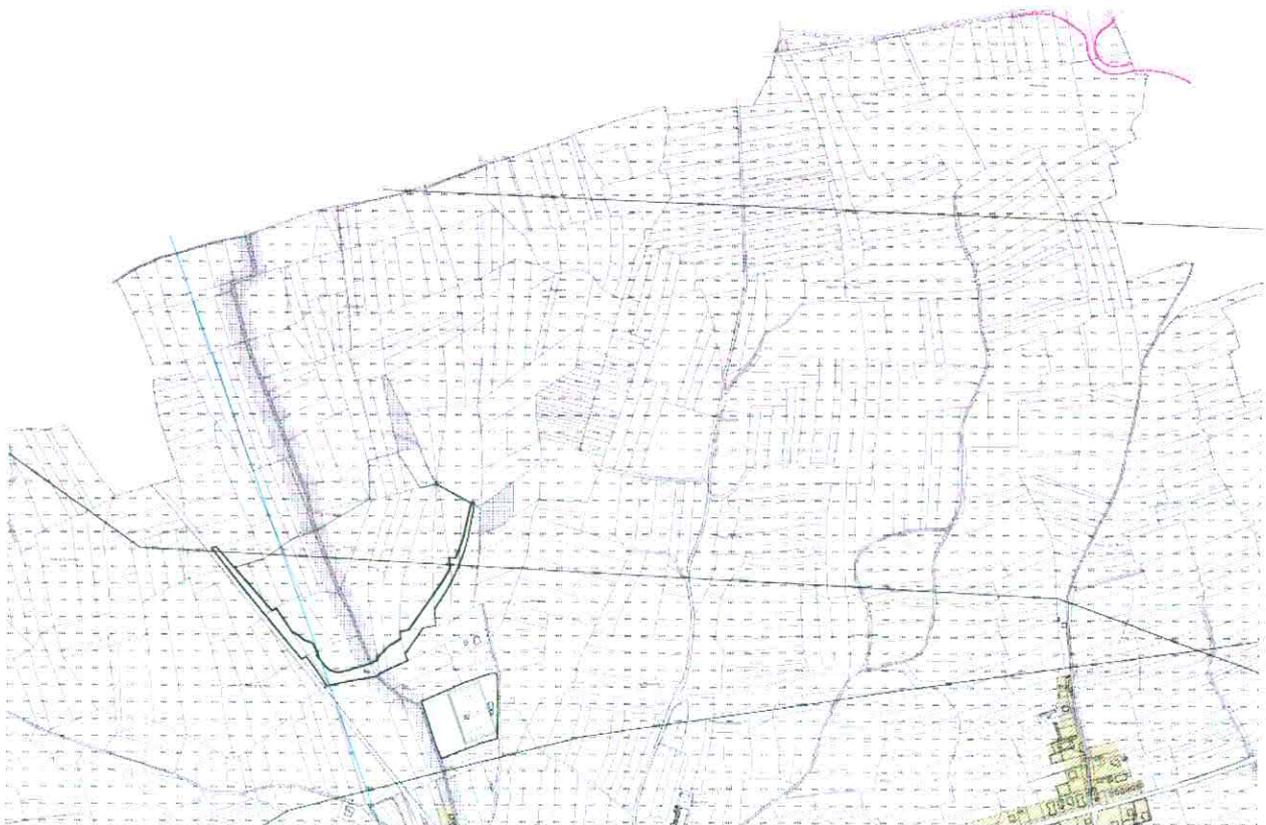
Nella tavola del Piano Regolatore è evidenziata la presenza di un'opera idraulica di ritenuta, realizzata dal Consorzio Ledra Tagliamento costituita da un argine in terra che, con il suo andamento a ferro di cavallo, viene a conglobare una superficie dell'ordine di 10 ettari, nei quali è possibile invasare un quantitativo di circa 90.000 mc d'acqua provenienti dal rio Lavia.
