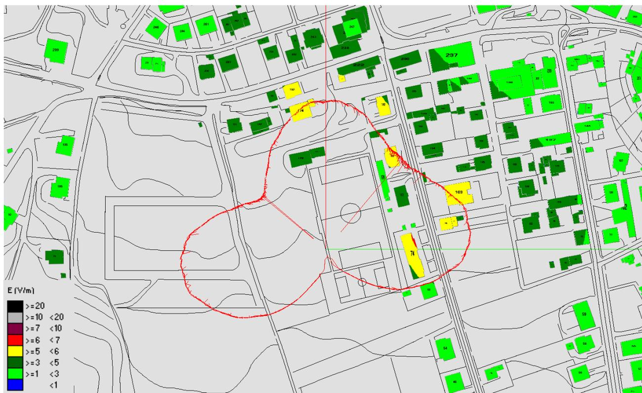
Fig. 8 Impatto Elettromagnetico – zona Via Schiratti Ip1 – Vista dall'alto senza solido
