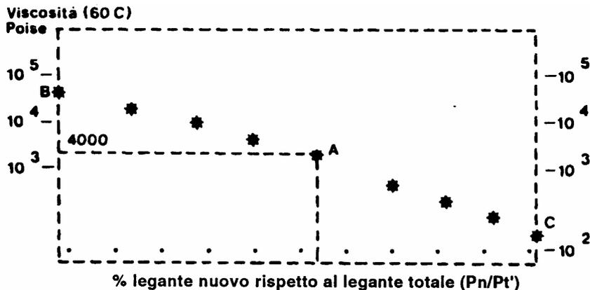
Indicando con A il punto le cui coordinate sono: il valore ottenuto di Pn/Pt ed il valore della viscosità di 4000 poise, l'intersezione della retta con l'asse verticale corrisponde al valore 100 dell'asse orizzontale, fornisce il valore C della viscosità del legante che deve essere aggiunto.
