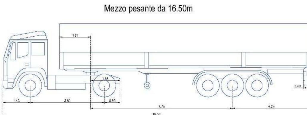
Figura 11 – Mezzo utilizzato per la verifica dimensionale della rotonda
