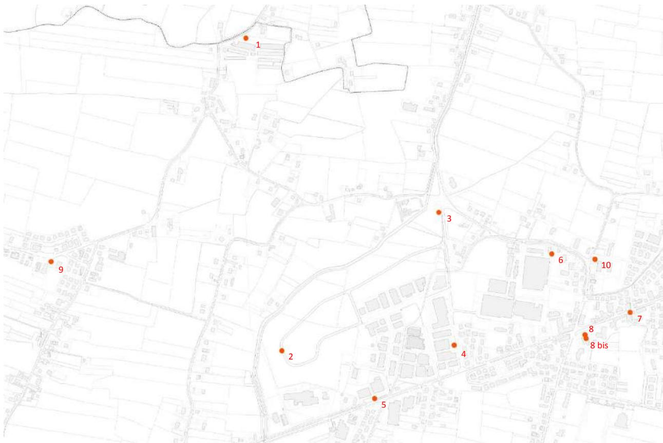
I rilievi eseguiti sono di tipo “spot” (breve periodo – 15 min.) in tutti i punti di misura eccetto che nel punto di misura 7, dove si è effettuato un monitoraggio nelle 24 ore (dalle 20:00 del 09/05/2016 alle 20:00 del 10/05/2016) al fine di verificare il rumore determinato dal traffico veicolare in corrispondenza della S.P. n. 3.
