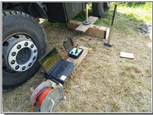
*Strumentazione per indagini sismiche*
