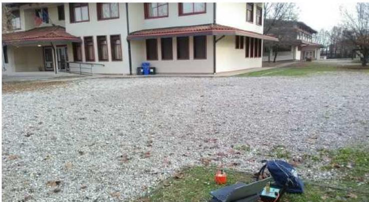
**Acquisizione sismica passiva
