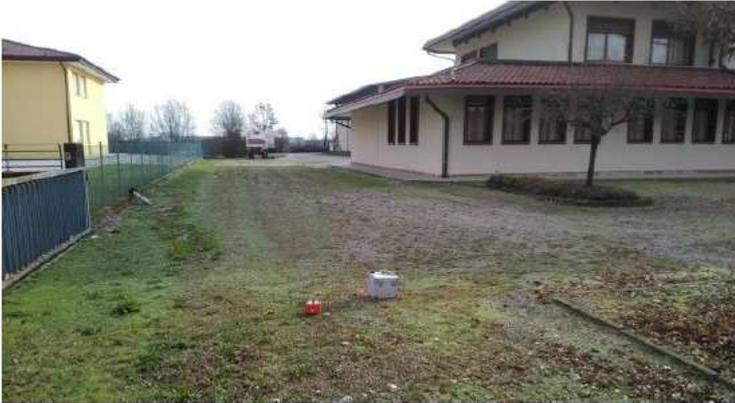
**Acquisizione sismica passiva
