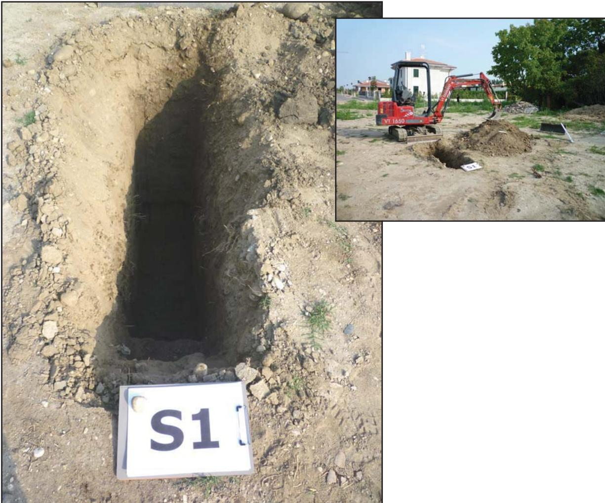
**Prova di permeabilità in pozzetto superficiale**
