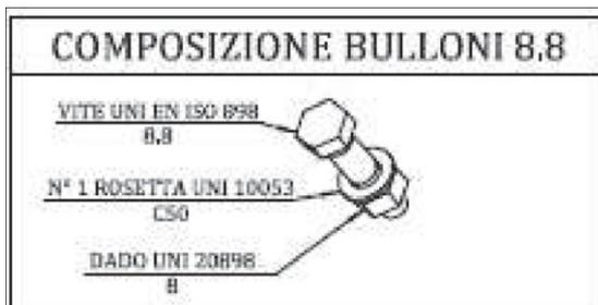
TUTTE LE GIUNZIONI BULLONATE DELLE STRUTTURE METALLICHE SONO CALCOLATE A TAGLIO E DOVRANNO ADOTTARE UN VALORE DI COPPIA DI SERRAGGIO PARI ALL'80% DEL VALORE PREVISTO PER LE GIUNZIONI AD ATTRITO COME DA CAP. 11.4 NTC 2008
